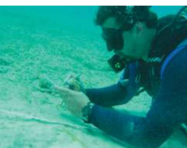
Χαρτογράφηση του πυθμένα και συλλογή δειγμάτων ιζημάτων με χρήση συσκευών αυτόνομης κατάδυσης.
